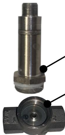
Plungerhülse vom Magnetventil lösen
