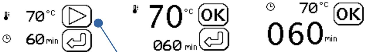
Durch Betätigung des Pfeils (**Start**) wird das Programm gestartet. Durch Berührung des Symbols „**Stop/Pause**“ kann das Programm pausiert oder abgebrochen werden.
