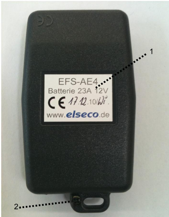
Auf der Rückseite des Handsenders finden Sie die Typenbezeichnung (1) des Handsenders. Zum Wechsel der Batterie ist eine Schraube (2) zu lösen.
