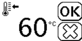
Nach der Festlegung des gewünschten Arbeitsmodus <sup>(14)</sup> kann es sinnvoll sein, die Vorheiztemperatur der Programmtemperatur anzupassen. Damit werden längere Aufheiz- oder Abkühlphasen vermieden. Die Vorheiztemperatur darf bis zu 8°C höher sein als die Programmtemperatur damit das Programm abläuft. Die Steuerung wird dann die Temperatur an den programmierten Wert anpassen (reduzieren).
