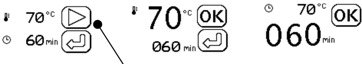
Durch Betätigung des Pfeils (**Start**) wird das Programm gestartet. Durch Berührung des Symbols „**Stop/Pause**“ kann das Programm pausiert oder abgebrochen werden.
