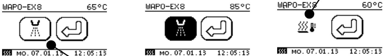
Durch berühren des **Ausbrüh-Symbols** wird der manuelle Ausbrühvorgang gestartet.
