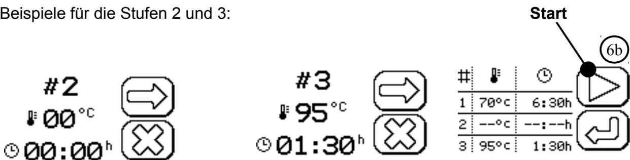
Durch Berührung des Pfeils (**Start**) wird der Polymerisationsvorgang gestartet. Durch Berührung des Symbols (**Stop/Pause**) kann das Programm pausiert oder abgebrochen werden.
