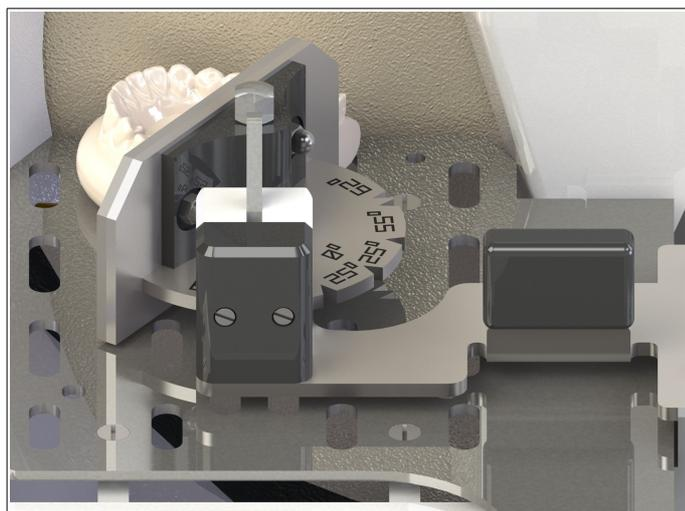
Arretierbarer Winkelanschlag, mit praktischer Winkelgravur, wegschwenkbar für uneingeschränkte Bewegungsfreiheit. Die Arretierung des Anschlages für das Beschleifen der verschiedenen Sockelkanten erfolgt durch eine präzise Verriegelung in die vorgegebene Winkelstellung (siehe Tabelle).
