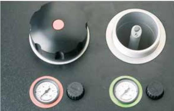
Strahlkammern mit individuellem Arbeitsdruck, 1-6 bar
