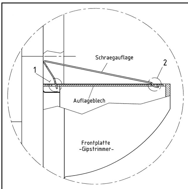
**Bei der Montage der Schrägauflage muss darauf geachtet werden, dass Pos. 1 und Pos. 2 im Auflageblech richtig eingerastet sind.**
