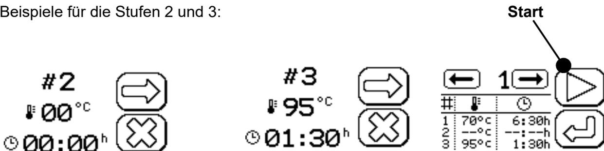
Durch Berührung des Pfeils (**Start**) wird der Polymerisationsvorgang gestartet. Durch Berührung des Symbols (**Stop/ Pause**) kann das Programm pausiert oder abgebrochen werden. Die weiteren Programmplätze 2 bis 13 werden äquivalent programmiert.
