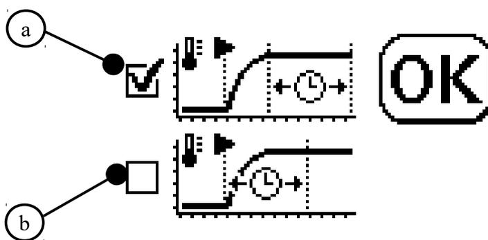
(a) (Default) Automat heizt auf die unter 6 programmierte Temperatur. Nach dem Erreichen dieses Wertes wird das Messergebnis durch einen Kontrollzyklus validiert. Wird der Wert bestätigt, beginnt der Polymerisationsvorgang.
